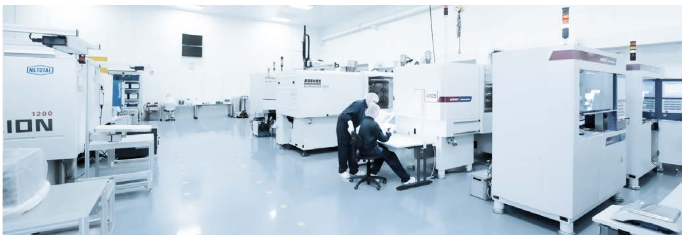
Unsere Kleinserienfertigung im Reinraum Klasse 8 nach DIN EN ISO 14644-1 in Wackersdorf, Deutschland
