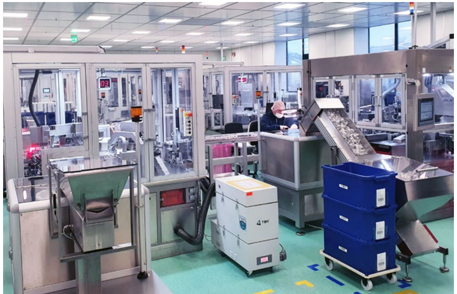
Vollautomatisierte Montageanlage für den Inhalator bestehend aus drei Rundtischanlagen
