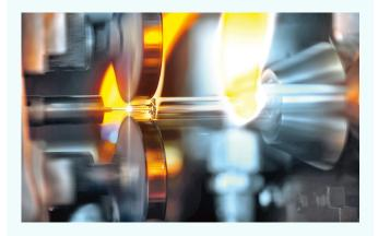
Eine speziell von Gerresheimer entwickelte und patentierte Produktionstechnologie sorgt dafür, dass der bei der Konusformung eingesetzte Dorn nicht mehr aus dem üblicherweise eingesetzten Wolfram oder einem alternativen Metall, sondern aus einer speziellen Keramik besteht. Damit kann der Einsatz von sogenannten seltenen Erden reduziert werden.
